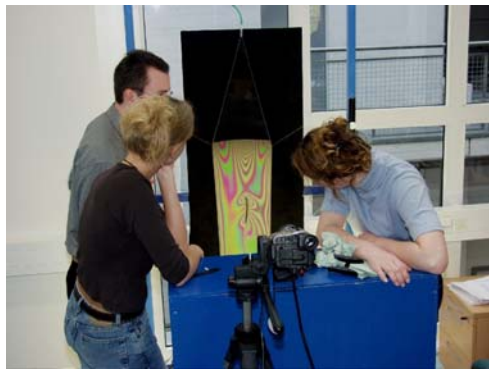
Bild 1: Am Seifenfilmkanal, einer der Lernstationen des DLR Schülerlabors in Göttingen, werden Strömungsphänomene untersucht mit einer optischen Interferenzmethode untersucht.
